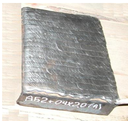
Рисунок 30 – Общий вид наплавленного образца для последующей прокатки
