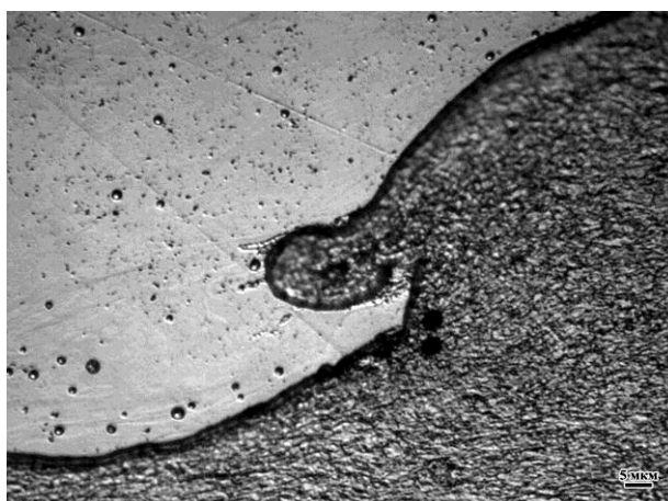
Рисунок 42 – Строение границы сцепления после сварки взрывом плакированной стали АБ2-2 + 04Х20Н6Г11М2АФБ.
