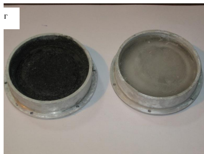
Рисунок 24 - Подготовка контрообразцов: а- ледяная крошка в смеси с абразивом; б - формование смеси; в - абразивная шкурка; г - контрообразцы после заморозки
